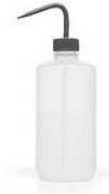
Figura 57: Matraz de lavado para la descontaminación del peine del lavador
