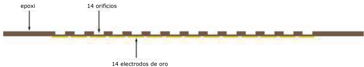
VISTA LATERAL DEL CANAL DEL MÓDULO DE SENSOR DESPUÉS DE IMPRIMIR LA MEMBRANA
